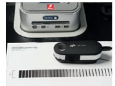
Le spectrophotomètre ES-2000 est utilisé pour étalonner l'imprimante et obtenir ainsi des dégradés plus progressifs et homogènes, ainsi que des impressions plus homogènes au sein d'un même tirage et entre moteurs d'impression.
